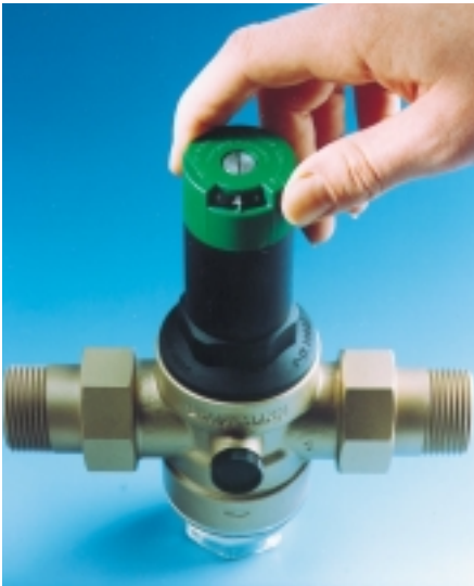
Bild 4: Ein Druckminderer wird durch Spannen der Sollwertfeder eingestellt. Der Wert „4“ gibt den Hinterdruck in bar an.
