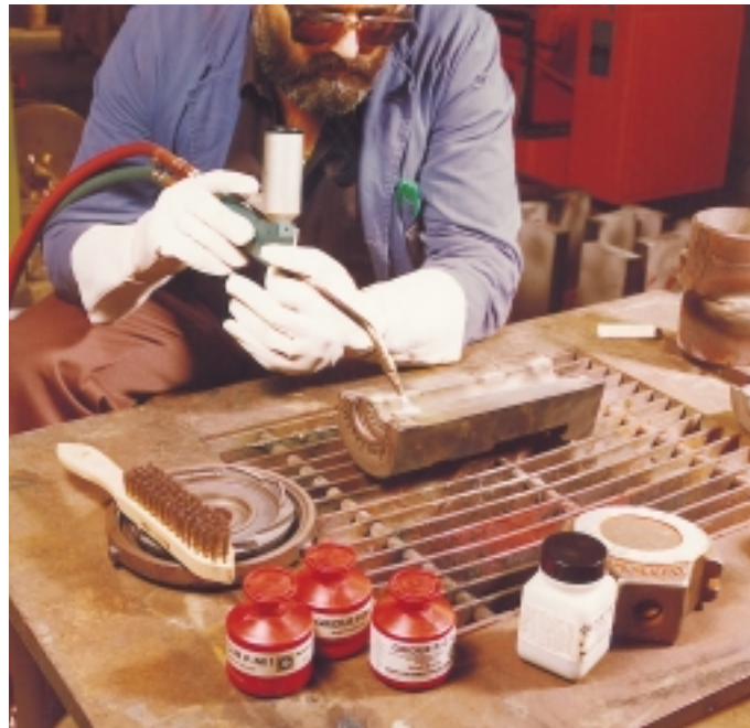
Bild 3: Instandsetzen einer Glaspreßform durch Gas-Pulver-Auftragschweißen (Foto: Messer-Griesheim).
