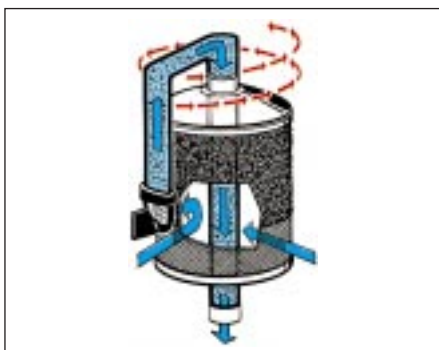
Bild 3a: Punkt für Punkt wird mit 50 km/h der Siebeinsatz mit filtriertem Wasser abgesaugt.
